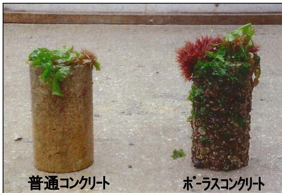
【 供試体の海中投入による経過実験（1ヶ月後）】
