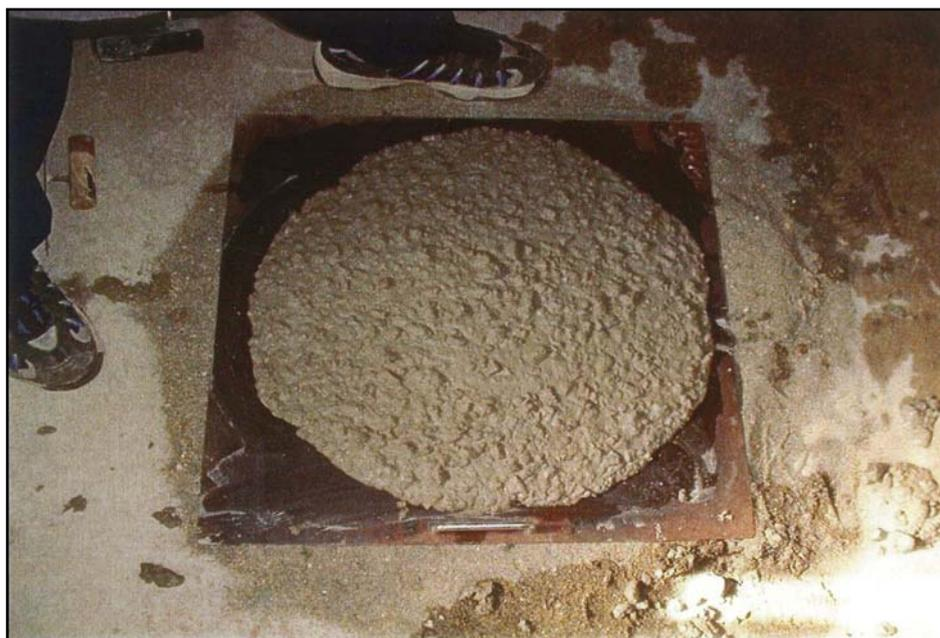
【水中不分離コンクリートのスランプフロー試験状況】
